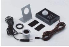
Der IR-Repeater empfängt die Infrarot-Sendeimpulse von handelsüblichen Infrarot-Fernbedienungen marktgängiger AV, Hi-Fi und TV Geräte und überträgt diese Impulse auf die hinter der Möbeltür platzierten Geräte. Das Empfängergeraue wird in einem Aufsteller untergebracht. Die Kabellänge von Steckernetzteil bis IR-Sender: 180 cm, Kabellänge vom IR-Empfänger bis IR-Sender: 200 cm.
